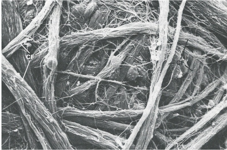
Figuur 3: Elektronenmicroscopische opname van collagene vezels, waarbij goed is te zien dat deze uit vele fibrillen zijn opgebouwd (Dynamiek van het menselijk bindweefsel, JJ de Morree, Bohn Stafleu Van Loghum, 1993)
